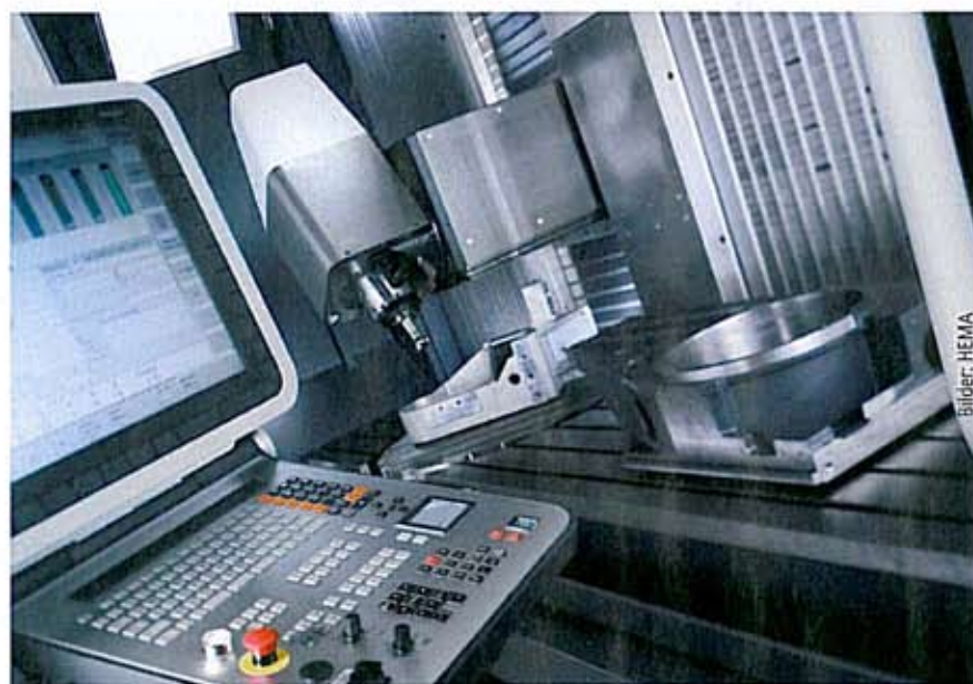
Die modular aufgebauten CUBE-Rückwandssysteme von HEMA reduzieren den Konstruktionsaufwand einer kompletten Schutzabdeckung für zwei Achsen erheblich.
