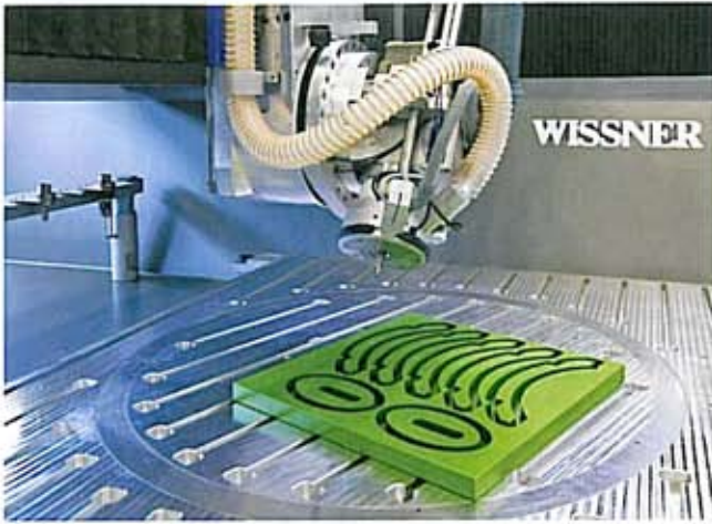
Einblick in die HSC-Fräsmaschine »Gamma« des Werkzeugmaschinenbauers Wissner, hier mit einem Vakuum-Spannsystem. Außer hoher Fertigungspräzision und vibrationsarmem Lauf erwartet der Betreiber von ihr eine absolut zuverlässige Not-Aus-Funktion
