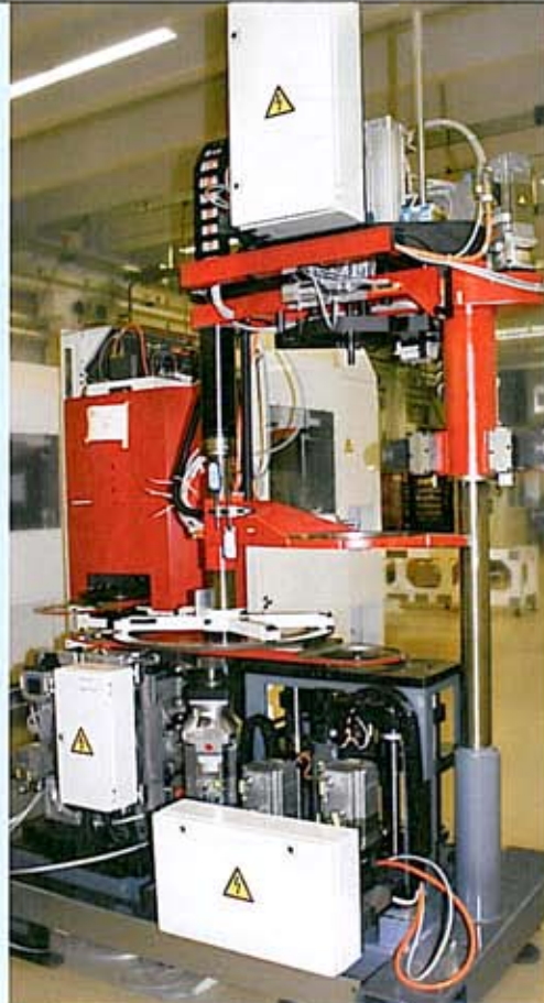
Oben: Die beiden Führungsstangen des Niederhalters laufen durch jeweils eine PClamp. Ist die Position des Niederhalters zum Fixieren des Werkstücks erreicht, klemmen die PClamp den Niederhalter zuverlässig fest.
