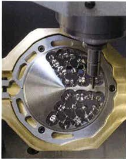
Der neu entwickelte Maschinentisch wurde als Palettenwechsler konzipiert und ermöglicht Werkstückwechsel nahezu ohne Umrüstzeiten.
