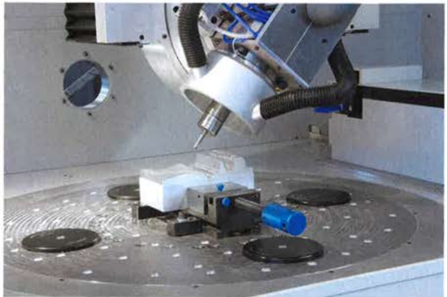
Im Modellbau sowie in der Kunststoff- und Holzverarbeitung werden zunehmend spezielle HSC-Fräsmaschinen eingesetzt.
