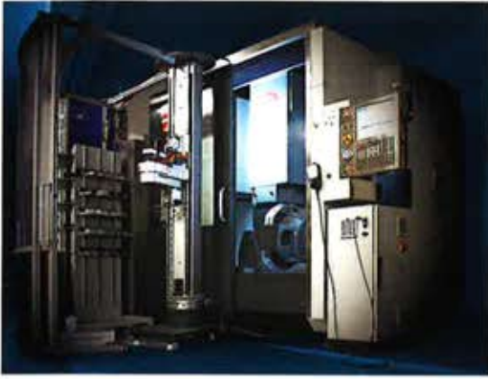
Im Originalzustand war die UMC 750 von Haas nach oben hin offen, die Dachabdeckung von Hema sorgt dafür, dass Späne, Dämpfe und Flüssigkeiten nicht nach außen gelangen. Foto: Hema
