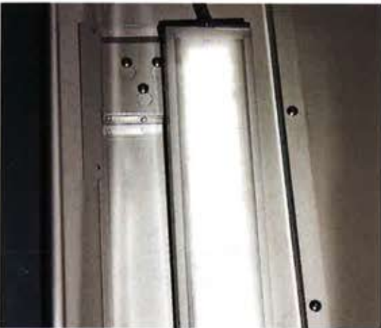
Katzenmeier verwendet auch die kompakt verbauten LED-Lampen von Hema, damit der Maschineninnenraum optimal ausgeleuchtet ist. Foto: Hema
