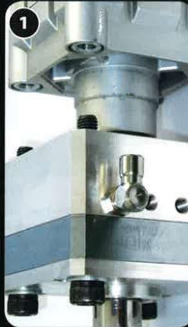
1 Die PClamp-Systeme von Hema verfügen über eine Sicherheitsfunktion: Bei Abschaltung oder Ausfall der Druckluft klemmen die Vorrichtungen selbsttätig und mit großer Kraft.
