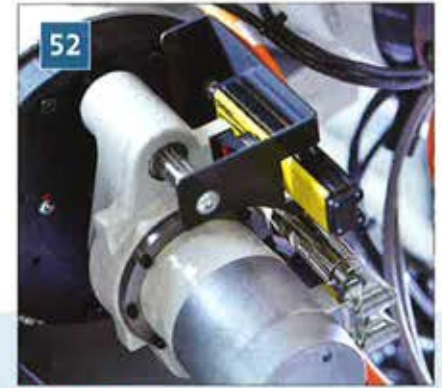
Edle Tropfen: Berührungsloser Linearwegsensor bringt Genauigkeit und die schnelle Abtastrate in die Kunststoffindustrie
