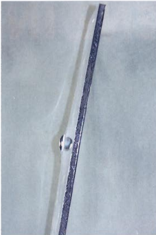
Sicherheitsscheiben aus Polycarbonat verformen sich beim Aufprall von Gegenständen lediglich. Foto: Hema
