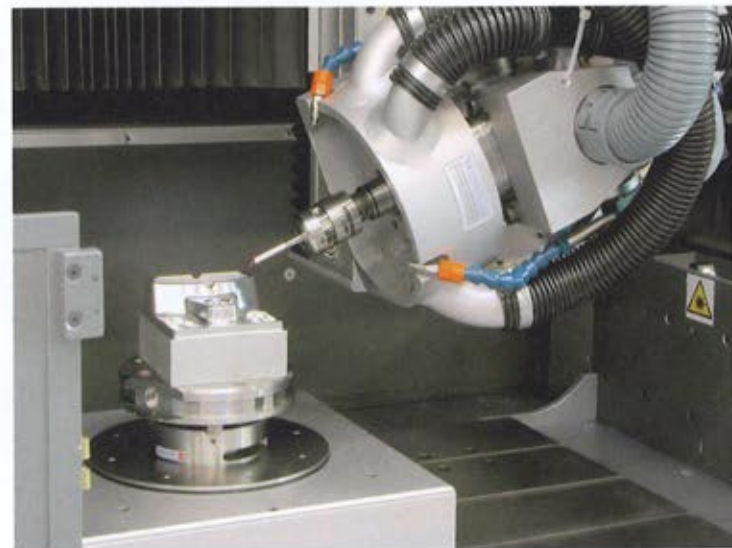
Die Maschinen der Gamma-Serie eignen sich besonders für den Modell- und Formenbau sowie die Mikrobearbeitung von Werkstücken. Bild: Hema
