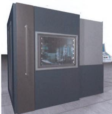
Die Rückwandsysteme des Fräszentrums werden modular gefertigt.
