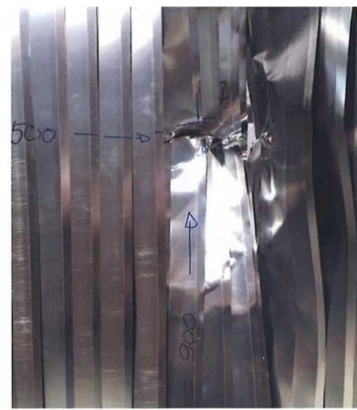
Die neu konstruierten Abdeckungen für die Rückwand eines 5-Achs-Fräszentrums mit Drehfunktion haben den Beschusstest bestanden.
