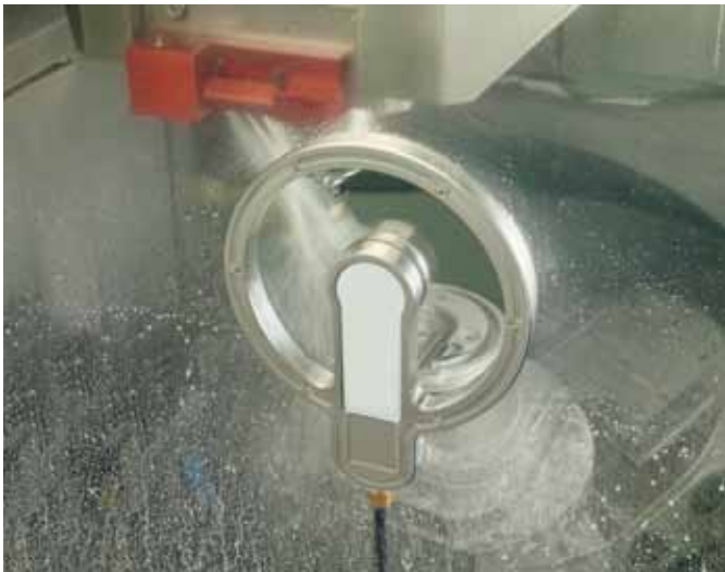
Die Drehfenster rotieren, je nach Baureihe, mit hohen Geschwindigkeiten von 2 235 bis 4 000 min -1 und verhindern so ein Anhaften von Kühlschmiermitteln und Spänen.
