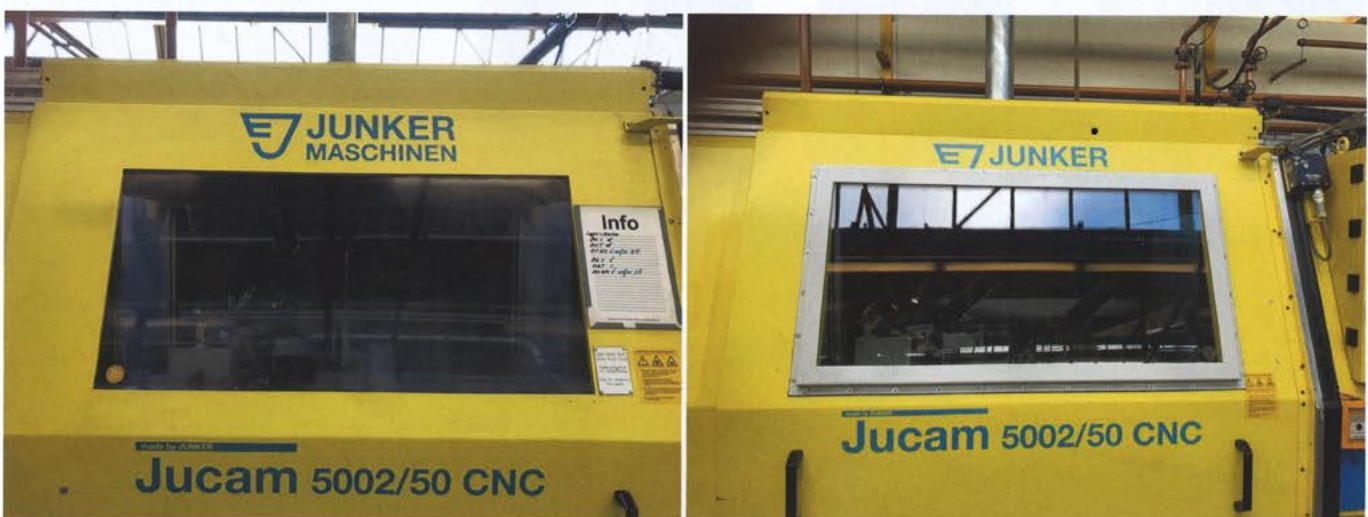
Bild 4: Vorher, nachher: Die alte Schutzscheibe (li.) ist erkennbar abgenutzt und bietet nicht mehr die volle Rückhaltefähigkeit. Mit der gekapselten Sicherheitsscheibe von HEMA ist das Personal wieder gut geschützt (Bild: SHS Iug & Stahl OHG, Affalterbach)
