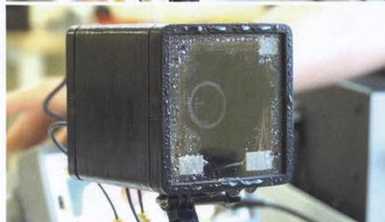
3 Klare Sicht binnen Sekunden: oben: Vor Aktivierung der Ultraschallwandler – die benetzte Kamera (links) liefert ein entsprechend unklares Kamerabild (rechts); unten: durch Aktivierung der Ultraschallwandler wird die Kameraoptik gereinigt und von Flüssigkeitstropfen befreit (© Hema)
