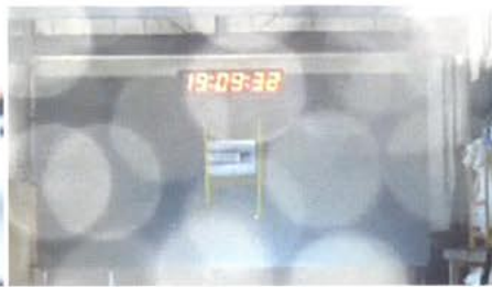
Die benetzte Kamera vor der Aktivierung der Ultraschallwandler. Aus Kameraperspektive zeigt sich die schlechte Sicht.
