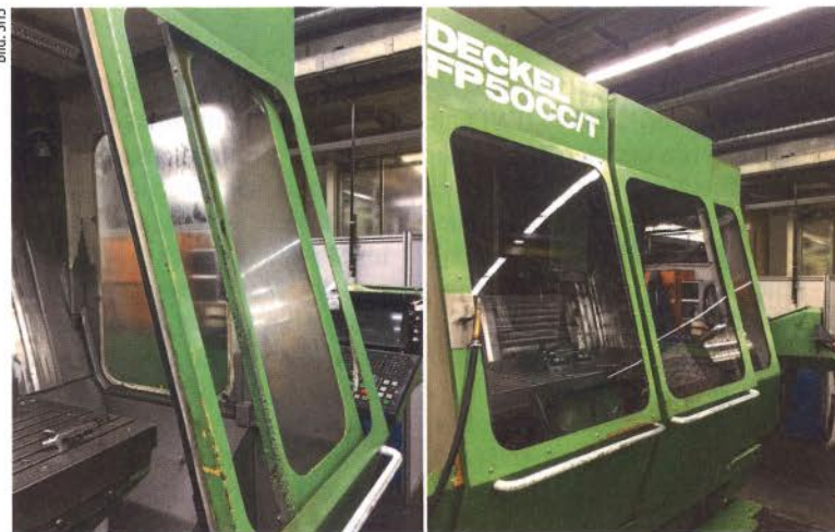
Einfache Sicherheits-scheiben aus Polycarbonat (li.) tauscht SHS gegen neue Modelle aus Polycarbonat und Spezialglas von Hema.
