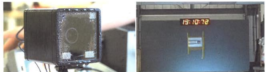
Bild 5. Die Kameraoptik wurde binnen Sekunden gereinigt und von Flüssigkeitstropfen befreit. Bild: Hema
