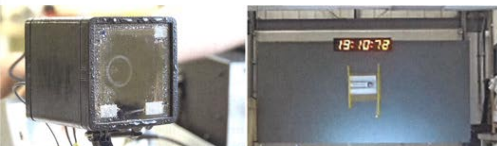
Die Kameraoptik wurde binnen Sekunden gereinigt und von Flüssigkeitstropfen befreit. Bild: Hema
