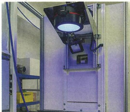
Nach dem Falzen und Beschriften wird die Beschriftung mittels Klarschrifterkennung validiert. Anschließend erfolgen der Aufdruck eines Labels sowie die Validierung des Labels. Über das Förderband werden die OK-Teile ausgegeben.
