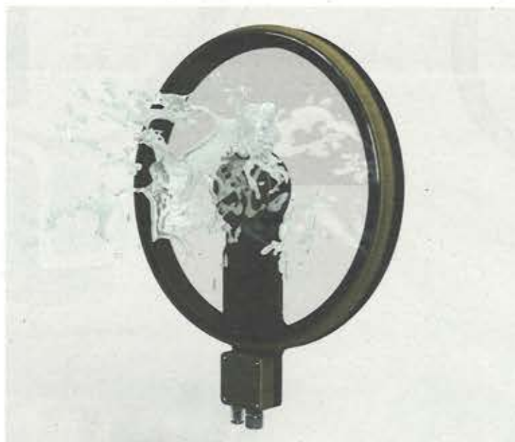
Dank Labyrinthkonstruktion und optionalem Überdruck sind die SPINVISTA extrem überspüldicht, und die Drehscheibe bremst innerhalb weniger Sekunden auf eine nichtkritische Drehzahl.
