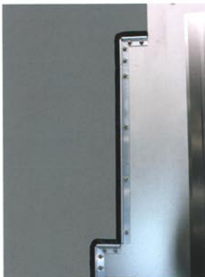
Bild 4: Die HEMA-Trennwand schließt die Querschnittsgeometrie des Maschineninnenraumes mit Hilfe von Abstreifern an den Kanten komplett ab (Bilder: HEMA GmbH, Seligenstadt)
