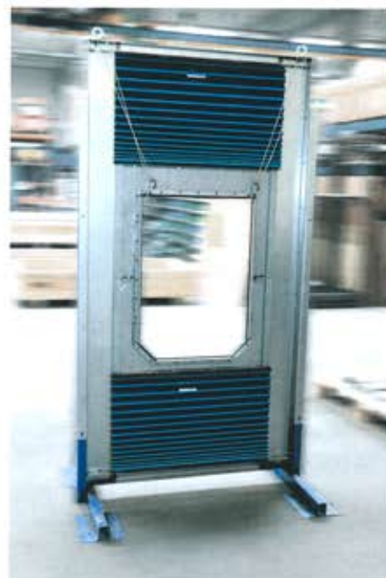
Mittelstück der HEMA-Rückwand für ein Bearbeitungszentrum für große Werkstücke kurz vor der Auslieferung zum Kunden
