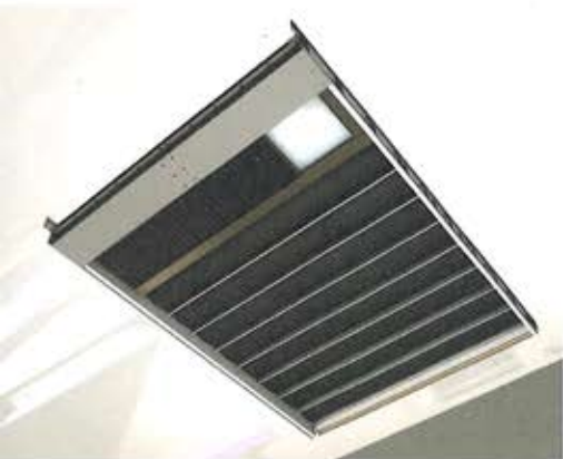
Blick von der Unterseite: Mit einer Fläche von rund 15 m 2 überspannt die Dachabdeckung den Arbeitsraum des 3D-Druckers.
